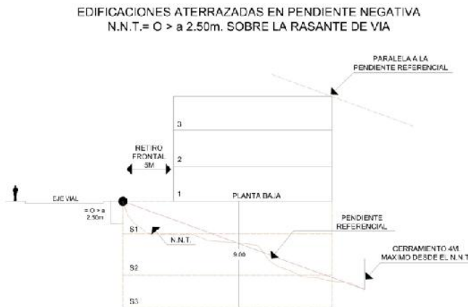
Figura 22. Edificaciones Aterradas en Pendiente Negativa con N.N.T. = > -2.50 m.
