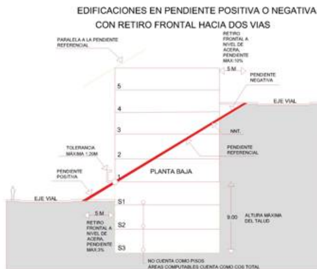
Figura 12. Edificaciones con pendientes Positiva o Negativa
